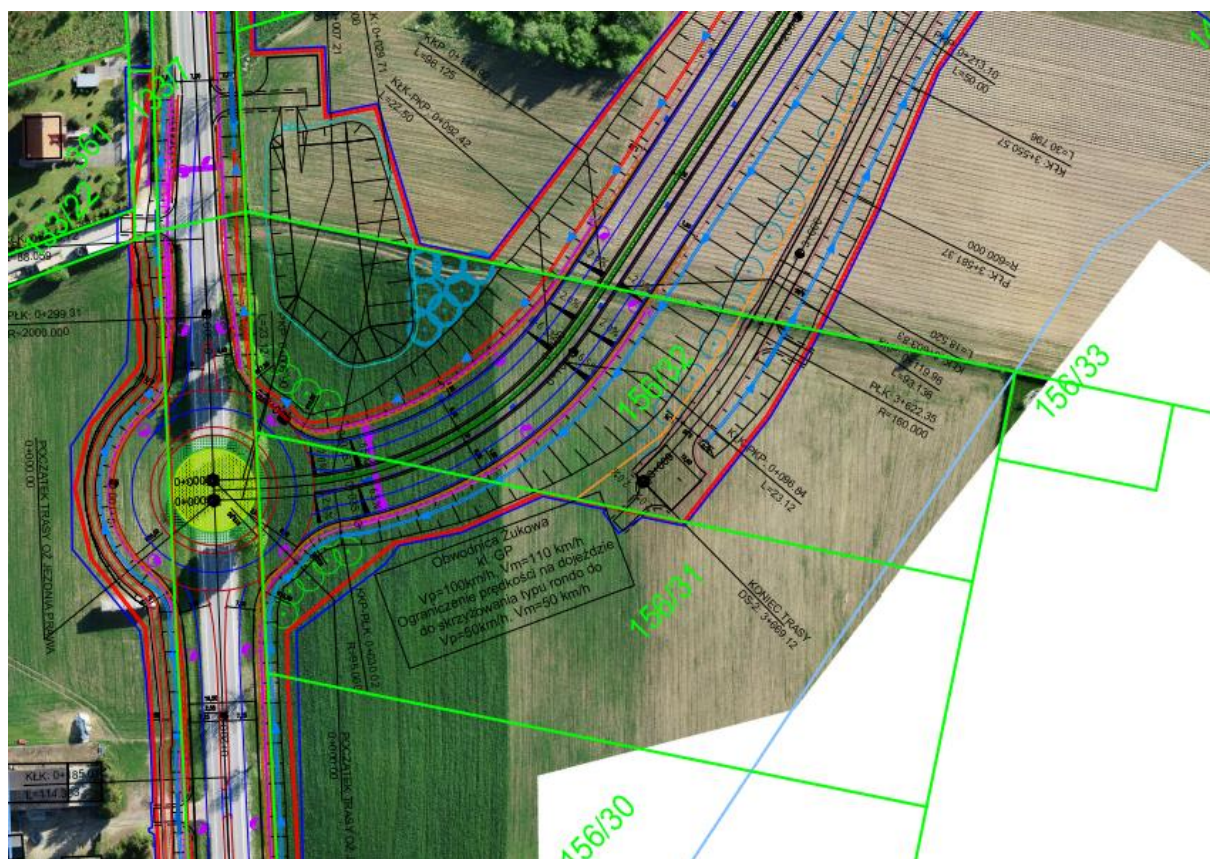
Rys.2 – projekt skrzyżowania typu rondo na połączeniu DK20 i DK7
